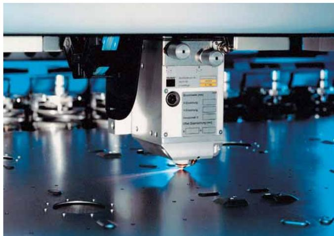
**Exakte Konturen** durch die Kombination von Stanzbearbeitung und Laserschneiden
