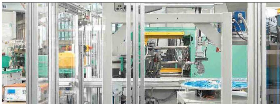
Las principales características del proceso de moldeo por inyección son el sistema de canal caliente con tres agujas de cierre con control externo para la inyección secuencial, así como los sensores del molde para controlar la presión y la temperatura. Para fabricar la lupa durante el proceso de moldeo por inyección, el molde está equipado con un troquel.
