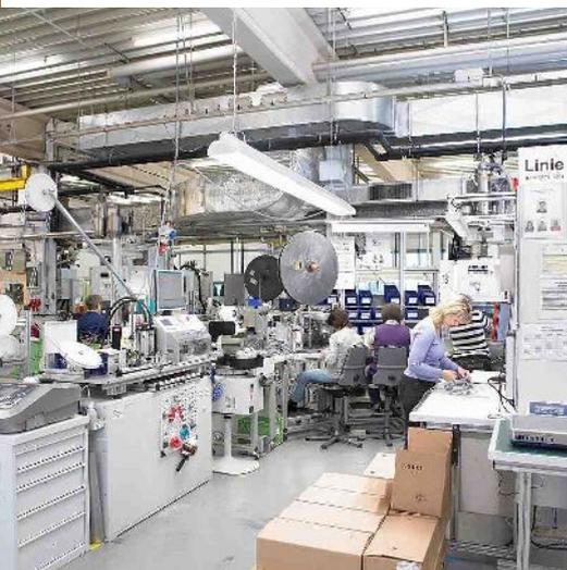
control de proceso para conexiones reproducibles y una ALLROUNDER 275 V vertical. Gracias a su sistema abierto y al reducido tamaño de instalación, las máquinas verticales de ARBURG están predestinadas para esta aplicación. Además de la buena accesibilidad y bajo requerimiento de espacio destacan por su equipamiento técnico. El director de fábrica, Thomas Schulin, lo expone así: "Los husillos con control de posición nos permiten conseguir una estabilidad de proceso muy alta y con
