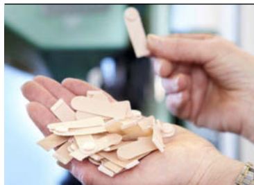
迄今为止，ALLROUNDER 150 (见上图) 仍在生产吊袜带带夹 (见左图)。
