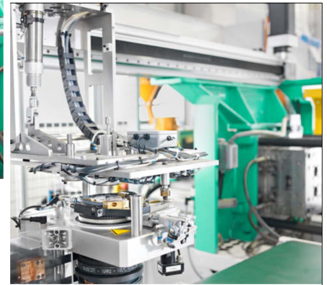
4 腔卡爪（见左图）驶入移交站（见右图），该站装备了四个带软管部分的卡爪核心。
