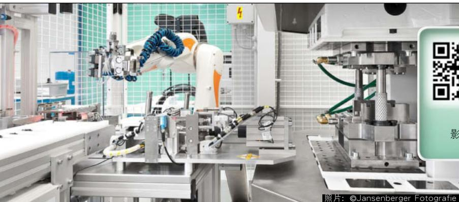
在自动化生产扩张器(左图)时,Teleflex 采用了 ARBURG (阿博格)的交钥匙解决方案(中图)。一台 ALLROUNDER 275 V 每次对四个插件进行注塑封装,由一个六轴机械手执行操作。
